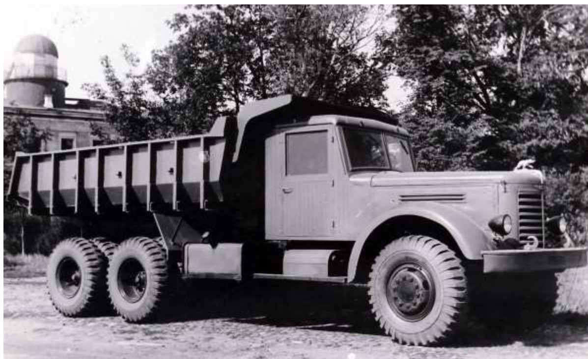
ЯАЗ-210 Е. Автомобиль самосвал, 3-х осный, грузоподъемностью 10 тонн. 1950 г.
